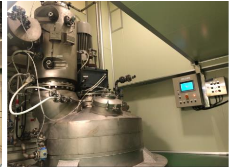
21 製程區之乾燥機人機連線測試
