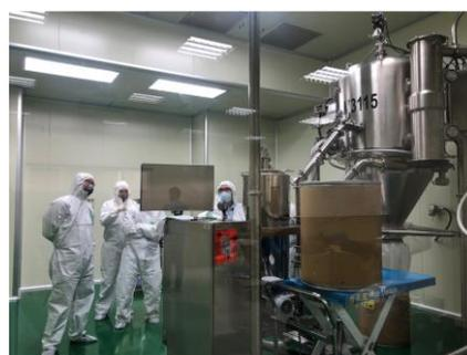
隨著 A 廠區第一階段復產的預訂時程一日日的推進，其 03B 製程區相關之生產前置作業逐一完成驗證，如：公共設施之蒸氣、冰凍水及氮氣等製程動力源皆已完成效能測試，確認供給 03B 製程區執行生產無虞；製程設備之反應槽及冷凝器等附屬設備，於本周已完成設備之操作驗證確效，如：設備設施之試漏試壓、關鍵參數之製程溫度/攪拌軸轉速及半自動化生產控制系統等，確認其製程效能可符合生產需求。且其潔淨室於本周亦完成內部裝修工程及環境感測元件控制連線，目前離心機之設備驗證與原廠技師們跨國連線作業，預計於近期完成。
