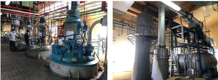
而 AL-1 及 Pent-2 精餾所需之第一座蒸餾生產設備，其動力源設施管路配管作業及冷卻系統細部修改皆已完備，於上周執行試運轉測試時，發現再沸器有洩漏狀況，由工程同仁反覆測試調整，並再執行測試確認其性能無虞後，於本週開始執行 AL-1 精餾生產試製，依蒸餾設備效能適時調整排程規劃，逐步改善問題來源，確保製程可依循規劃的工序進行生產。
