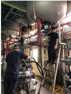
由試運轉確認設備間的連結運轉與操控性能無虞，正式執行製程設備之前清洗作業，確保製程設備清潔度及排除交叉污染的疑慮後，於本週正式生產中間體品項之 Pyrogallolaldehyde，因首次於租借廠房投入生產，故由研發及生產部門主管共同督導製程作業，確實掌握製程運作依循規劃的工序進行生產，確保移地生產之製程
