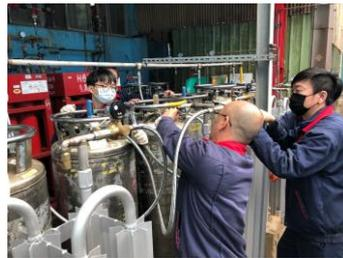
租借正峰廠房支應之移地生產，執行中間體正式生產前，生產同仁逐一執行製程設備功能之測試運轉，入水於製程設備執行試漏試壓及測試加熱、冷卻與傳輸等系統。在試運轉測試過程中，發生許多無預期之突發狀況，如空氣管破管、底閥洩漏及空壓機爆管等，工務及生產同仁集思廣益討論研判，逐一測試尋找問題來源，積極共同面對處理，即時修復及汰換更新等預防措施，確保製程可依循規劃的工序進行生產。
