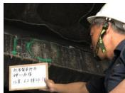
受損建築物之安全鑑定於本週展開取樣作業,鑑定流程需符合「財團法人全國認證公司基金會(TAF)」認證合格之機構執行作業,主要檢測項目為混凝土強度檢測、氯離子強度檢測、混凝土中性化深度檢測、垂直測量及燒失量等,由技師執行建築物現況記錄、經緯儀觀測法量測傾斜率及鑽心試體取樣,並拍照以供存查。取樣之樣品需委由 TAF 認證實驗室執行檢驗,建築師依據國家標準 CNS1238 及 CNS3090 等基準
