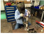
製程週邊設備配件亦同步進行查檢及製管備料,由生產同仁查檢製程週邊設備狀態,在清潔及拆裝過程中,逐步確認設備零件與耗材可用性及汰換更新,確實執行試漏試壓以確保設備性能可正常運作,並由工務同仁依製程需求製作特規客製化配件及傳輸管等,以供生產,即時備援。
