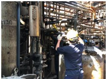
廠區可執行之初步清運作業於本週告一段落，部門主管逐一查勘完成洩料之生產設備的效能狀態，因廠區內部之電力供應設施仍持續執行修復作業，故僅能由目視評估其可用性，並將生產設備的效能評估彙整成表，以討論後續修復的因應對策，由管理階層規劃今年回復生產線的廠區，將優先執行建築物修復及設備新購等重建作業。部分生產設備經評估為局部毀損，可經由修復補強或更換零件回復其可用性；
