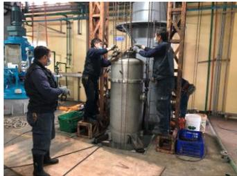
承租正峰廠房支應之移地生產，目前持續執行製程設備之細部修改，主要分為管件管路之優化作業及蒸餾生產設備之建置作業。
