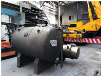
因移地生產之中間體的製程設備需求，由研發同仁與工務同仁共同規劃，結合專業製程與實務經驗，規劃建置蒸餾生產系統於租借廠房。依製程板數需求，查勘廠區現有之蒸餾生產系統，所幸符合需求之蒸餾生產系統僅輕微燻黑，且蒸餾塔之保溫層無燒融狀態，僅毀損部分電源管線及配接管線等可容易替換之附屬配件。
